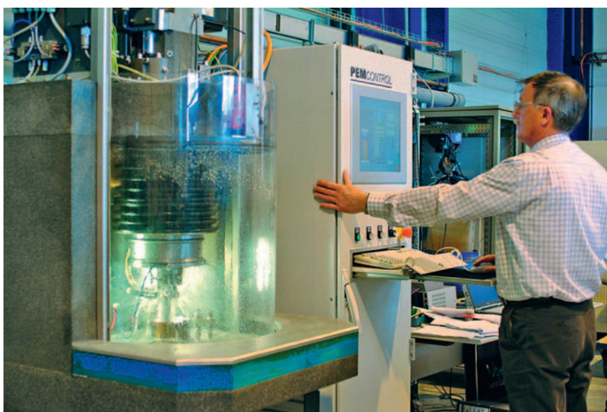
Bild 5: Ansicht einer Precise-ECM-Anlage: Mit ihr können hochproduktiv und präzise Werkstücke erodiert werden, die bisher so wirtschaftlich nicht herstellbar waren.
